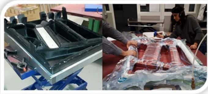
la tecnica non distruttiva per la sua analisi pre e post test. E' stata completata la campagna di caratterizzazione del materiale ISICOMP® mediante l'esecuzione dei seguenti test: - Test Oxidation/Emissivity/ Catalysis @CIRA - PWT SCIROCCO e Test di esposizione ad Atomic Oxygen @ ESA-ESTEC. E' stata avviata la realizzazione del secondo componente del manufacturing model del flap.
